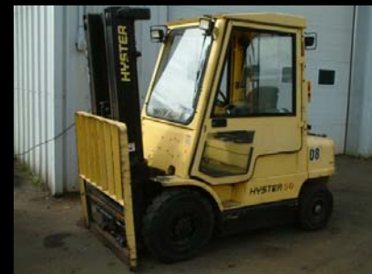
2002 Hyster Pneumatique H50XM Mat 3 stages 83-189" Side Shift Propane
